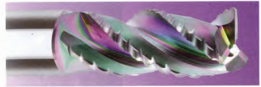
Der VHM-HPC-Alu-Schrupfräser „Primus“ mit Innenkühlung und Multidrall ist konsequent auf extrem hohe Vorschübe bei ruhigem, vibrationsarmem Lauf und geringer Leistungsaufnahme ausgelegt.
